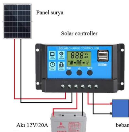
Gambar 4.3 Pengkabelan unit catu daya
